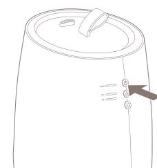
**OBS!** Strøm-/vannnivåindikatoren vil blinke rødt hvis det er for lite vann i vannbeholderen under bruk.
