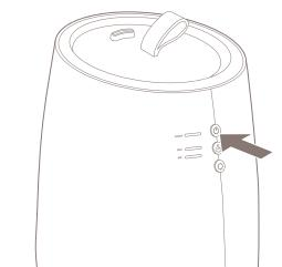
**Obs!** Ström-/vattenindikatorn blinkar rött om det inte finns tillräckligt med vatten i behållaren vid användning.
