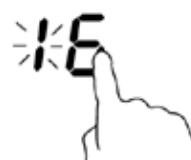
Aseta aika liukukytkimellä (esim. 9). Nyt ajastin on asetettu 96 minuutille.
