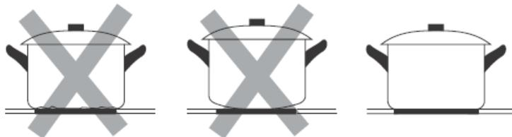
Tjek at grydens/pandens bund er flad, at den ligger plant mod glaspladen, og at den har samme størrelse som varmezonen. Benyt gryder/pander med en diameter der svarer til zonens størrelse. Hvis gryden/panden er noget bredere end varmezonen, er energiforbruget mest effektivt. Hvis den er mindre end varmezonen, forringes effektiviteten. Har gryden eller panden en diameter under 140 mm, registreres den muligvis ikke af enheden. Placer altid gryden/panden i midten af varmezonen.
