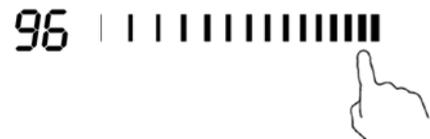
Ajastin alkaa laskea taaksepäin heti, kun aika on asetettu. Näyttö näyttää jäljellä olevan ajan ja ajastinnäyttö vilkkuu 5 sekuntia.
