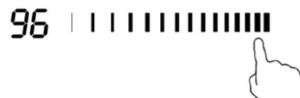
Når tiden er innstilt, starter nedtellingen umiddelbart. Displayet viser gjenværende tid, og tidsurindikatoren blinker i 5 sekunder.
