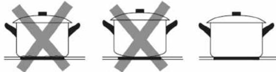
Försäkra dig om att kockärets botten är slät, att den ligger plant mot glashällen och att den har samma storlek som värmezonen. Använd kockärl som har samma diameter som den valda zonen. Om kockäret är något bredare arbetar zonen på max. effekt. Om du använder ett något mindre kockärl kan effekten bli lägre än förväntat. Kockärl med diameter som är mindre än 140 mm riskerar att inte detekteras av hällen. Placera alltid kockäret i värmezonen centrum.
