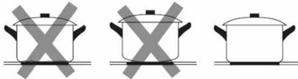
Påse at bunnen på kokekaret er jevn, ligger godt en mot glasset og har samme størrelse som kokesonen. Bruk kokekar med en diameter som tilsvarer det som er angitt på induksjonstoppen. Hvis du bruker et kokekar som er litt større, bruker du strøm på maksimal effekt. Bruker du et mindre kokekar, kan effekten være lavere enn forventet. Det er ikke sikkert at induksjonstoppen registrerer mindre kokekar enn 140 mm. Sett alltid kokekaret midt på kokesonen.
