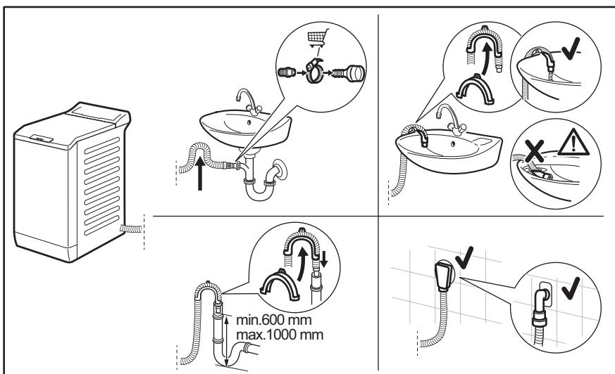
Tömningsslangen ska sitta på en höjd som inte är lägre än 600 mm och inte högre än 1 000 mm.
