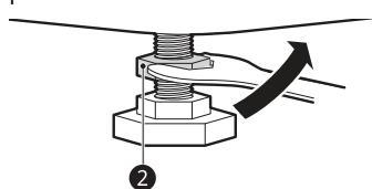
**4** Kontrollera att alla låsmuttrar vid apparatens undersida är ordentligt fastspända.
