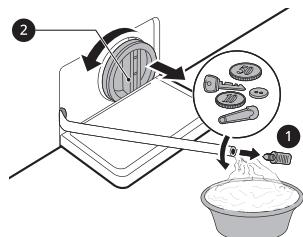
**4** Sett varsomt inn filteret til avløpspumpen igjen etter å ha rengjort det, og skru varsomt avløpsdekselet på med klokken for å unngå feilgjenging og lekkasje. Sett pluggen tilbake i avløpsrøret og sett røret i holderen.
