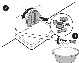
**4** Efter rengøring af afløbspumpefilteret skal du forsigtigt indsætte filteret igen og skrue afløbshætten tilbage med uret for at undgå skævdrejning og lækkage. Sæt stikket ind i afløbsslangen igen, og placér røret i dets holder.
