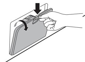
**3** Fjern først afløbsproppen fra afløbsslangen **1**, og aftap derefter vandet. Skru derefter afløbspumpefilteret **2** langsomt ud for at aftappe det resterende vand, og fortsæt derefter med at fjerne alt affald eller alle genstande fra filteret.
