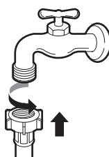
**Tilslutning af slangen til apparatet**
