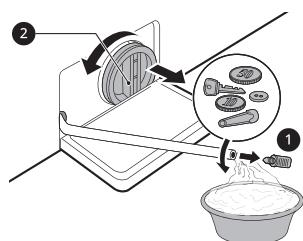
**4** Efter rengöringen av avloppspumpens filter, sätt försiktigt tillbaka filtret och skruva tillbaka avloppslocket medurs. Var noga med att gängorna inte hamnar fel och läckage uppstår. Sätt tillbaka pluggen i avloppsslansen och placera den i sin hållare.
