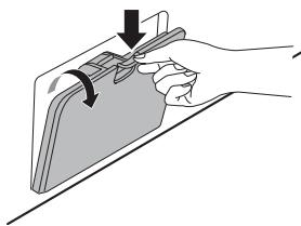
**3** Fjern avløpspluggen fra avløpsrøret først ①, og drener så ut vannet. Skru deretter sakte løs filteret til avløpspumpen ② for å drenere ut gjenværende vann, og gå videre til å fjerne eventuelt rusk eller gjenstander fra filteret.
