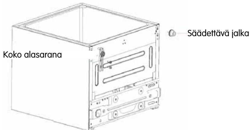
6. Nosta ovi varovasti alasaranalle; varmista, että ovitiiviste asettuu tiiviisti paikalleen. Kiinnitä tämän jälkeen ylösarana ja ylösaranan suojuus. Asenna lopuksi reiän peitelevy oikeaan yläkulmaan.
