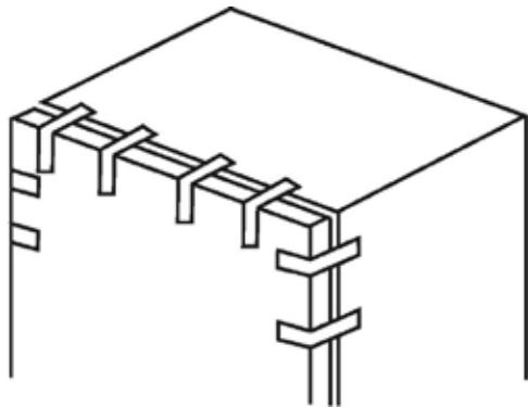
2. Fjern beskyttelsesdæksler til huller, øverste hængselsdæksel og skruer, som holder øverste hængsel på plads. Fjern derefter det øverste hængsel. Hold i døren, så den er lodret, når du gør dette (ellers kan den løsne sig og falde ned på gulvet).
