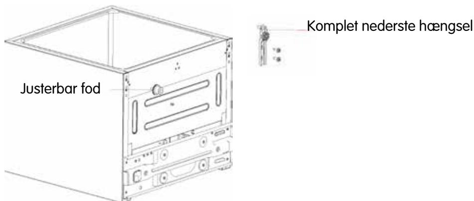
5. Installer det nederste hængsel og den justerbare fod på produktets venstre og højre side.
