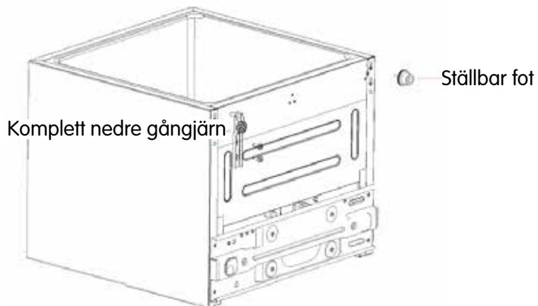
6. Häng på dörren på det nedre gångjärnet (försäkra dig om att dörrpackningen tätar ordentligt). Sätt därefter fast det övre gångjärnet med skruvarna och gångjärnsskydd. Avsluta med att sätta fast skyddslock för hål på övre höger sida.
