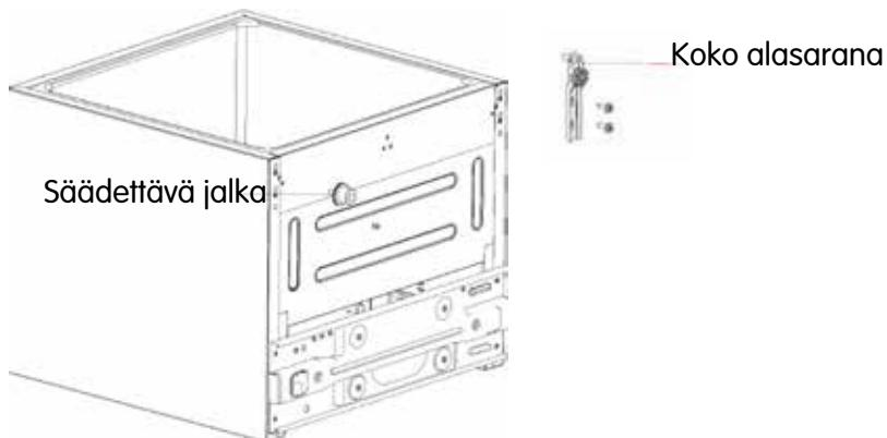
5. Asenna alasarana ja säädettävä jalka laitteen vasemmalle ja oikealle puolelle.
