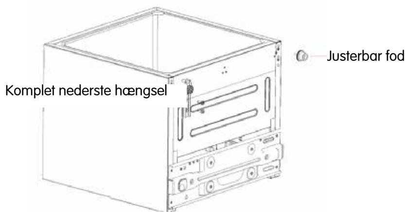
6. Hægt døren på det nederste hængsel (kontrollér, at døren lukker ordentligt til). Fastgør derefter det øverste hængsel med skruerne og hængselsdækslet. Afslut ved at fastgøre et beskyttelsesdæksel til huller øverst i højre side.
