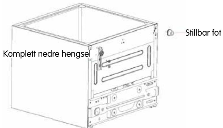
6. Heng døren på det nedre hengselet (forviss deg om at dørpakningen tetter ordentlig). Sett deretter fast det øvre hengselet med skruene og hengselbeskyttelsen. Avslutt med å sette fast beskyttelseslokk for hull på øvre høyre side.
