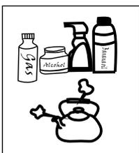
Använd inte hård borste, rengöringsbollar av rostfritt stål, stålborste, produkter med slipeffekt som tandkräm, organiska lösningsmedel (alkohol, aceton, bananolja etc.), kokande vatten, syrabaserade eller alkaliska rengöringsmedel för att rengöra kylan (kylens yta och insida kan skadas). Skölj inte med vatten (den elektriska isoleringen kan försämrars).
