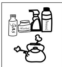
Ikke bruk hard børste, rengjøringsballer av rustfritt stål, stålbørste, produkter med slipeeffekt som tannkrem, organiske løsemidler (alkohol, aceton, bananolje osv.), kokende vann, syrebaserte eller alkaliske rengjøringsmidler for å rengjøre vinskabet (skapets overflate og innside kan skades). Ikke skyl med vann (den elektriske isolasjonen kan svekkes).
