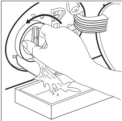
5. När skålen är full av vatten, vrid för att sätta tillbaka filtret och tömma behållaren.
