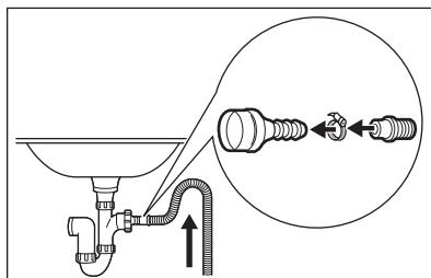
Sørg for at det er en bøy på avløpsslangen, slik at smuss fra vannlåsen ikke kommer inn i apparatet.
