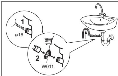
Anslut tömningsslangen till avloppsmuffen och dra åt med en klämma. Kontrollera att tömningsslangen gör en loop för att förhindra att partiklar kommer in i maskinen från tvättstället.
