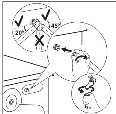
2. Posisjoner den mot venstre eller mot høyre avhengig av hvor vannkranen er plassert. Kontroller at inntaksslangen ikke er i en vertikal posisjon.
