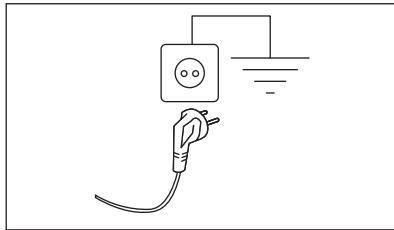
Nätkabeln måste vara lätt att komma åt när maskinen har installerats.
