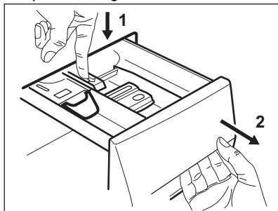
2. Fjern den øverste delen av kammeret for tilsetningsmidler for å bidra med rengjøringen, og skyll den under rennende varmt vann for å fjerne oppsamlet vaskemiddel. Etter
