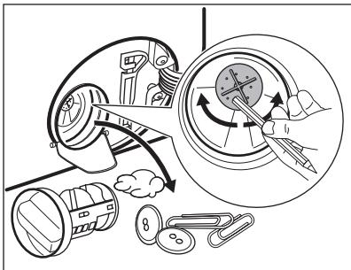
10. Rengjør filteret under vannkranen.
