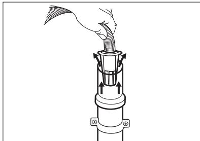
4. Til et vertikalt rør med luftehull - sett avløpsslangen direkte inn i et avløpsrør. Se illustrasjonen.
