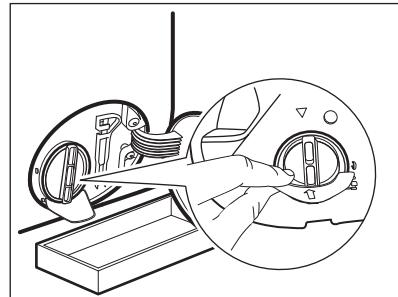
4. Vri filteret 180 grader i mot klokken for å åpne det, uten å fjerne det. La vannet renne ut.
