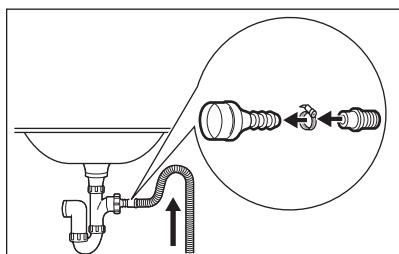
Kontrollera att tömningsslangen gör en loop för att förhindra att partiklar kommer in i maskinen från tvättstället.
