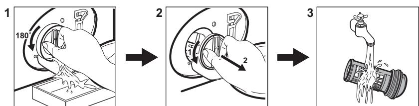
Rengjør filteret regelmessig og spesielt hvis alarmkoden **E20** vises på displayet.
