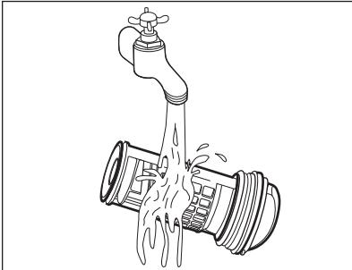
11. Sätt tillbaka filtret i styrkenorna genom att vrida det med sols. Var noga med att dra åt filtret ordentligt för att förhindra läckage.
