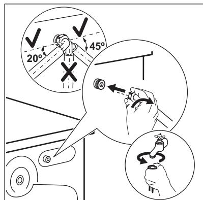
2. Sätt den på vänster eller höger sida beroende på var vattenkranen sitter. Kontrollera att tilloppsslängen inte är i vertikalt läge.
