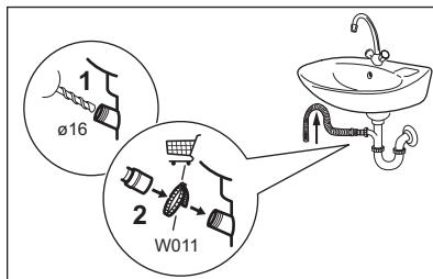
Koble avløpsslangen til rørstussen og fest den med en klemme. Sørg for at det er en bøy på avløpsslangen, slik at smuss fra vannlåsen ikke kommer inn i apparatet.
