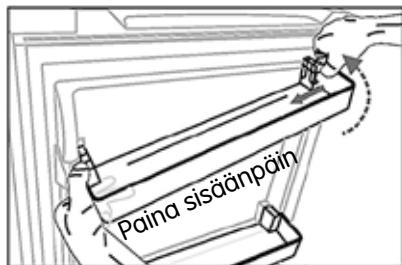
Pidä kiinni ovihyllyn vasemmasta sivusta ja paina oikeaa sivua sisäänpäin. Kun hylly on irti kiinnikkeistä, ota se pois vetämällä vinosti ylöspäin.
