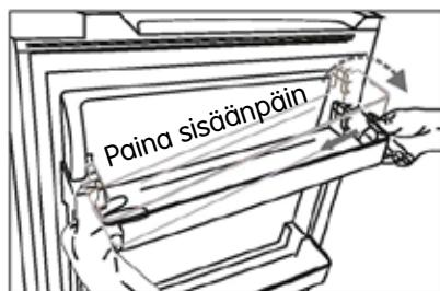
Kallista ovihyllyn vasenta sivua ja ohjaa ura oven kiinnikkeeseen. Paina sen jälkeen oikeaa puolta sisään- ja alas päin, kunnes hylly on paikallaan oikein.
