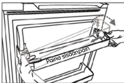
Käännä ovihyllyn vasenta puolta alaspäin ja varmista, että hylly asettuu oikein kiinnikkeeseen. Paina sen jälkeen oikeaa puolta sisään- ja alaspäin, kunnes pääty napsahtaa paikalleen.
